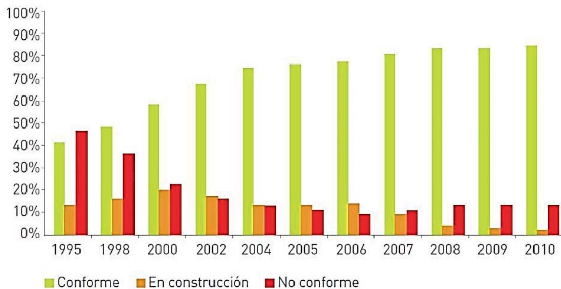
Figura 11. Grado de conformidad del estado de depuración de aguas residuales en España con la Directiva 91/271/CEE. 1995-2010, de acuerdo con el informe de la OSE de 2012.
